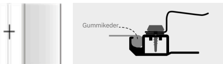
Querschnitt Rahmenprofil mit Schraube und Klemmwinkel
