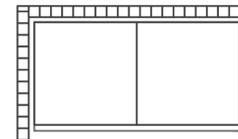
Arbeitsplatten werden "schwimmend" befestigt. Lassen Sie zwischen den Wandseiten und der Arbeitsplatte stets **3-5mm** Abstand frei, um Ihnen den **Einbau** zu erleichtern und **Wandunebenheiten** vorzubeugen. Berücksichtigen Sie weiter, dass i.d.R. Ihre Arbeitsplatte über die Küchenunterschranke hervorstehen soll. Als Daumenregel gelten **2-3cm Überstand**.
